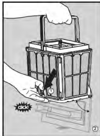
6.1.4 Om het vuil te verwijderen, druk de vergrendeling omlaag voor het openen van de bodem.
